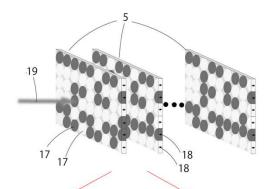
【課題を解決するための手段】光 入力信号が入力する磁性層を備ええ 該磁性層から光出力信号が出力される磁気光学演算素子であって、 光入力信号が直線偏光、円偏光も しくは楕円偏光のいずれかであり、 磁性層は磁気光学効果により光出力信号の偏光状態を変える磁気光 学材料を含み、磁性層が、光入力信号を推定可能な磁気光学回折ニューラルネットワークを形成する。
